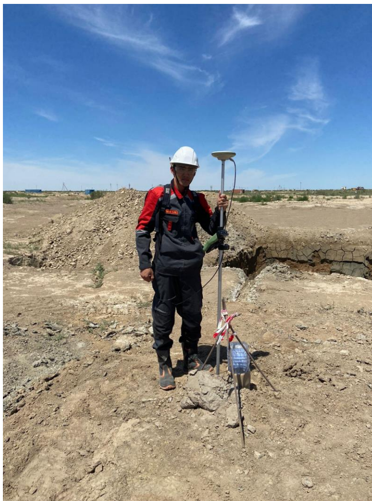
Сурет 16 - Leica CS10 басқарғышымен және Leica GS08 қабылдағышымен түсіріс жасау процесі
