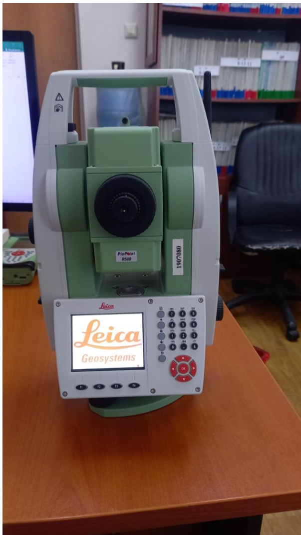
Сурет 17 - Электрондық тахеометр Leica TS09 plus R500 3”
